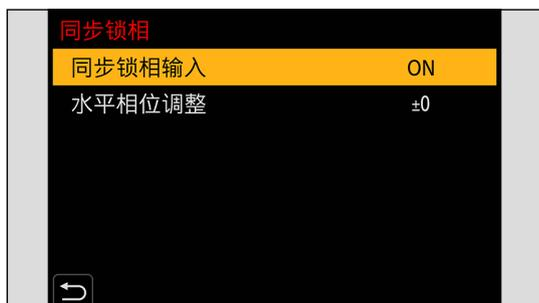
3 用同步信号发生器输出同步信号。
