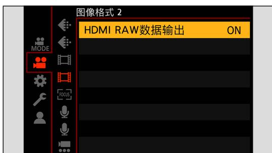
在将 [HDMI RAW 数据输出] 设为 [ON] 之后，使用安装了“LUMIX Tether”的 SDI 显示器或 PC 显示菜单画面并操作相机。
